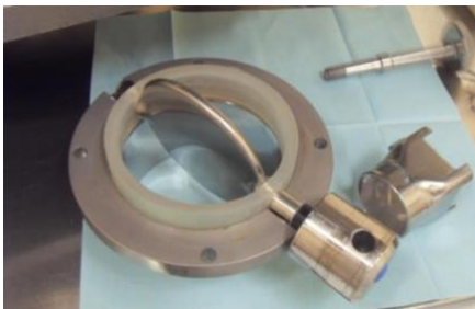
Figure 39 : Vanne de la trémie d'alimentation
