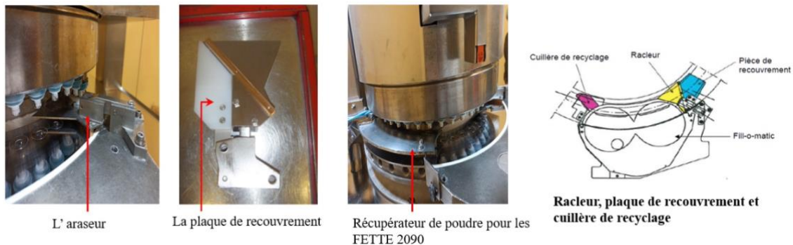
Figure 17 : Le racleur, la pièce de recouvrement, la cuillère de recyclage et le récupérateur de poudre
