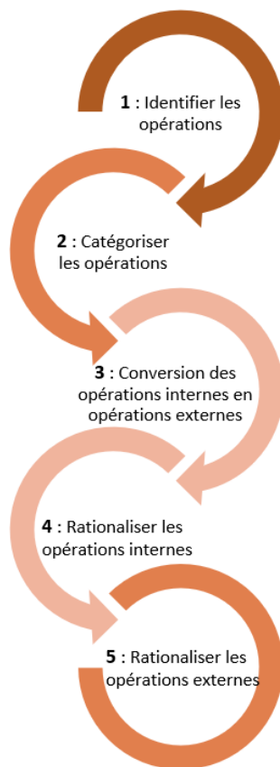
Figure 7 : Schéma des étapes de la méthode Single Minute Exchange of Die (SMED)
