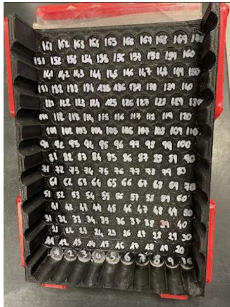
Figure 10 : Photographie du gabarit mis en place pour aide au double comptage des flacons.
