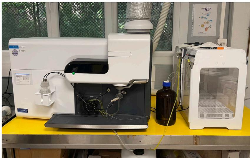
Figure 12 : Spectromètre d'émission atomique à plasma micro-ondes (MP-AES Agilent®).
