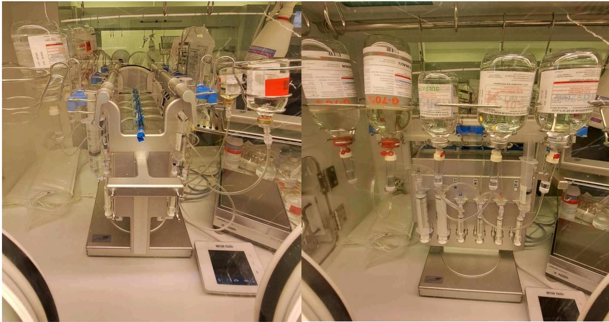
Figure 11 : Automate de préparation des nutriments parentéraux : MediMix® IMF
