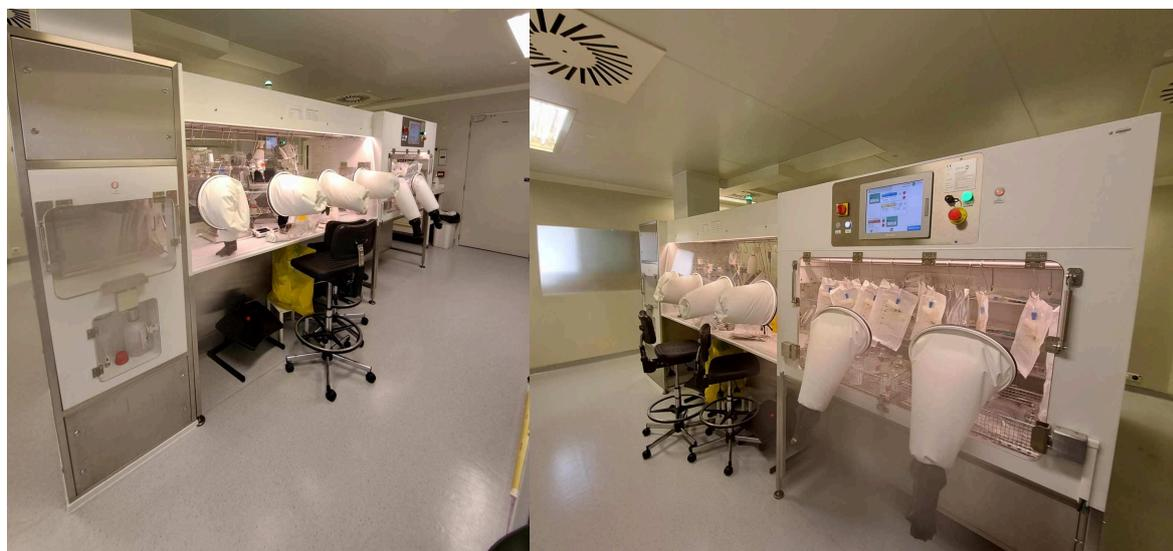
*Figure 10 : Isolateurs de l'unité de préparation des nutriments parentéraux.*
