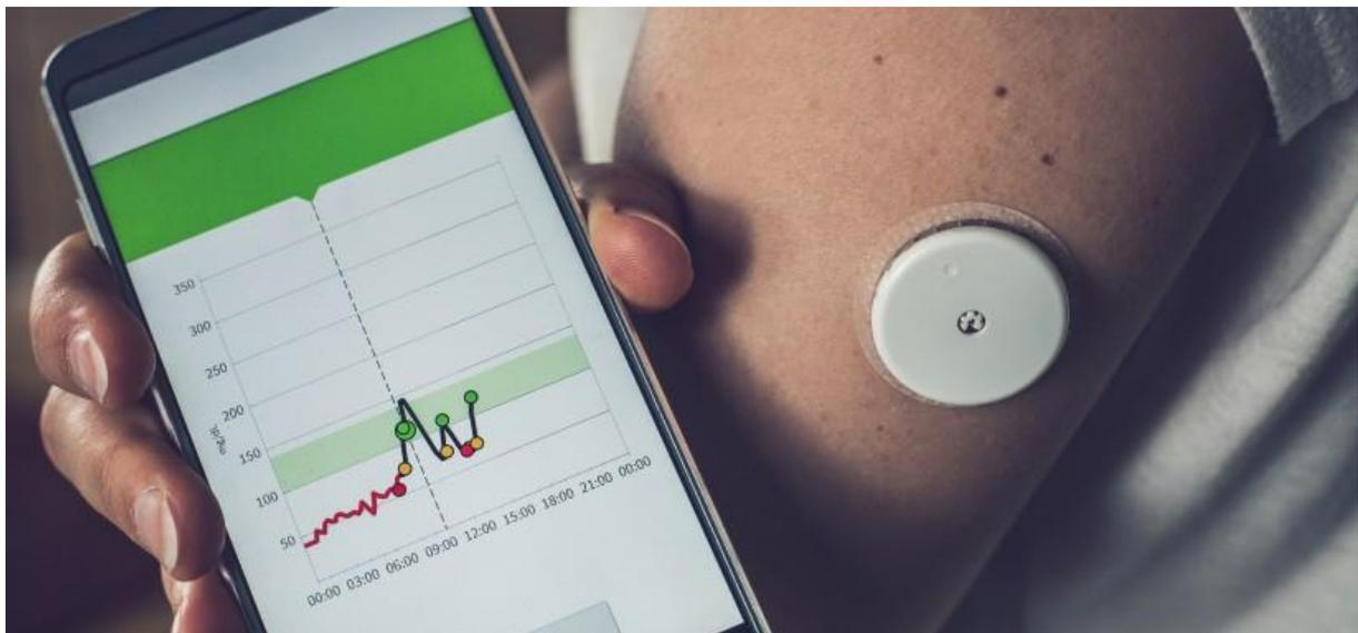
**Figure 17 : Photo d'un capteur avec suivi de la glycémie en direct (53)**
