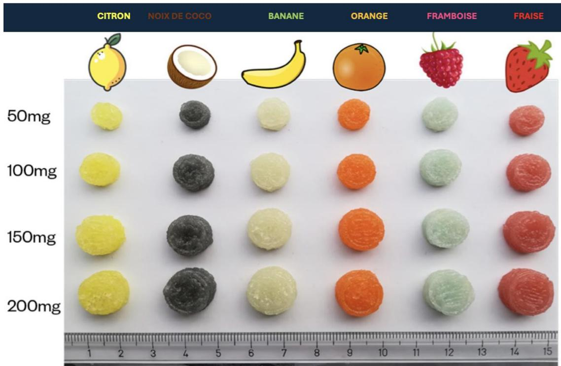
Figure 19 : Comprimés à mâcher avec différents arômes, couleurs et différentes doses d'Isoleucine pour la première étude clinique utilisant la fabrication additive pour traiter le syndrome du sirop d'érable chez les enfants (9)
