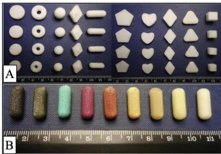
Figure 6 : (A) Image montrant la capacité de la technologie FDM à créer diverses formes, de différentes tailles.
