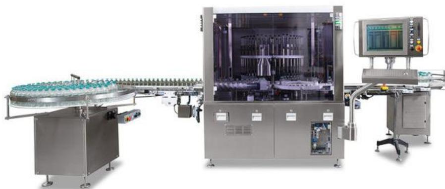
**Figure 8.** Équipement utilisé pour le mirage automatique (23)
