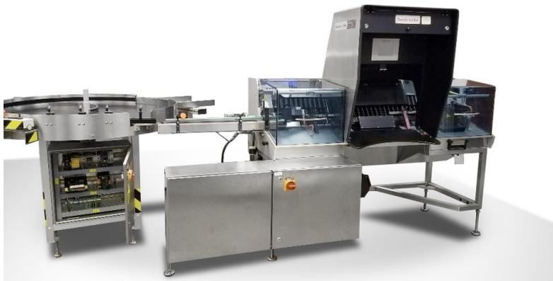
**Figure 7.** Équipement utilisé pour le mirage semi-automatique (26)
