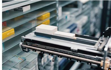
*Fig.33 : Photo du bras mécanique - BD Rowa Vmax*
