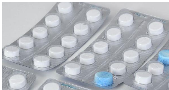
Figure 10. Exemples de blisters à l'issue d'un test d'étanchéité (75)
