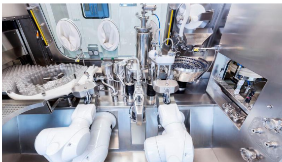
Figure 30 : Machine robotisée de remplissage de flacons Steriline (site de Staubli).
