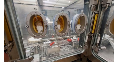
Figure 10 : Isolateur de répartition du service Lyophilisation.
