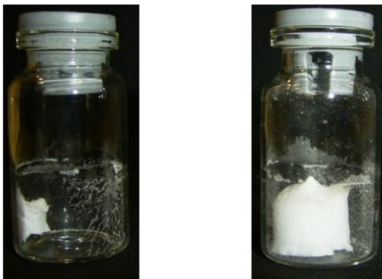
Figure 12 - Photo de flacons lyophilisés collapsés – Source : Référence (53)
